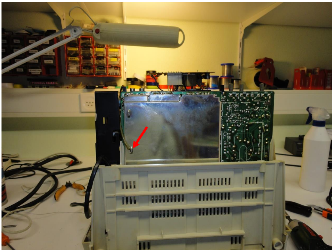
De massadraad bij de rode pijl lossolderen.
