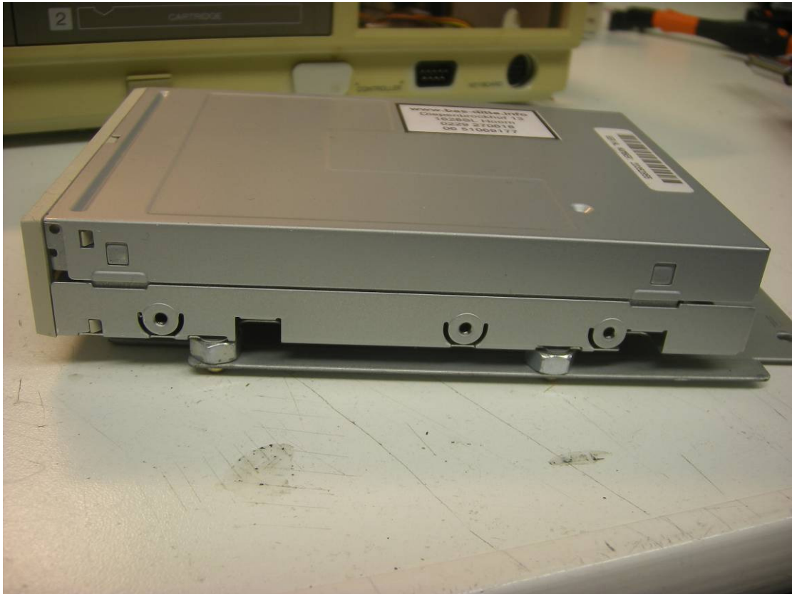
De nieuwe diskdrive met afstandsbussen op de bodemplaat
